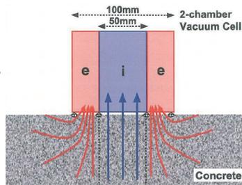
2チャンバーセルの仕組み
