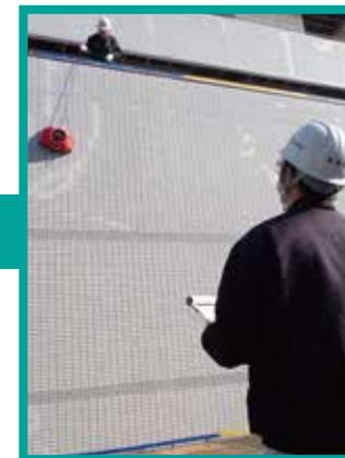
現場にて打診音から凡その浮き箇所を判定し、録画データから浮き位置を確認します。
