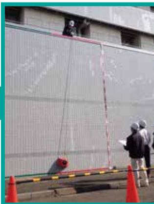
地上部にビデオカメラとワイヤレス集音装置を設置します。
